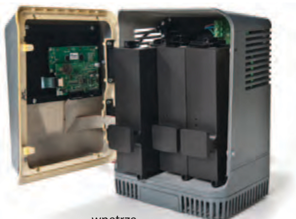
wnętrze 3-modułowego urządzenia
